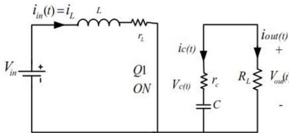
**Fig. 3.** Bosst converter  $0 < t < T_{on}$ .
