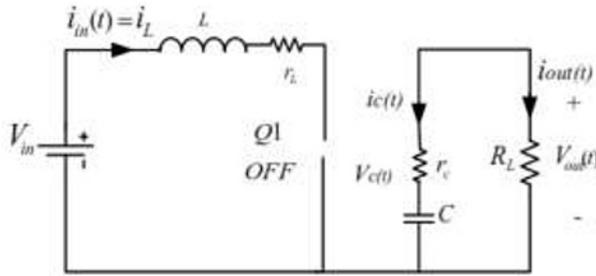
**Fig. 4.** Boost converter  $T_{on} < t < T$ .
